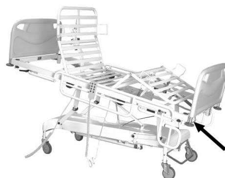
obecné umístění páčky Tr./ATr. u polohovacích lůžek
